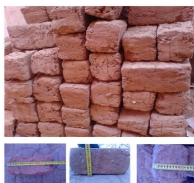
Figure 13: Dimensionnement des briques d'adobe.
