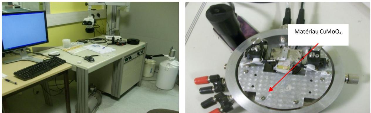
Figure 6 : Banc de mesure DLTS du LAAS.
