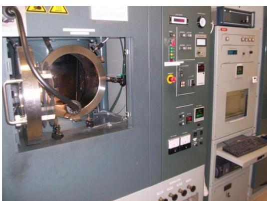
Figure 2 : Machine SPS de la Plate Forme de frittage Flash.
