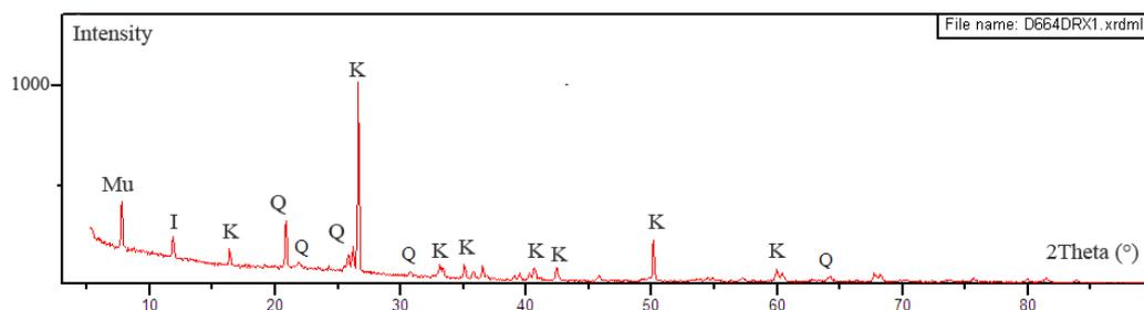
**Figure 1:** XRD patterns of Oulmès kaolinite-rich clay (ArgK). (K : Kaolinite, I : Illite, Q : Quartz, Mu : Muscovite).
