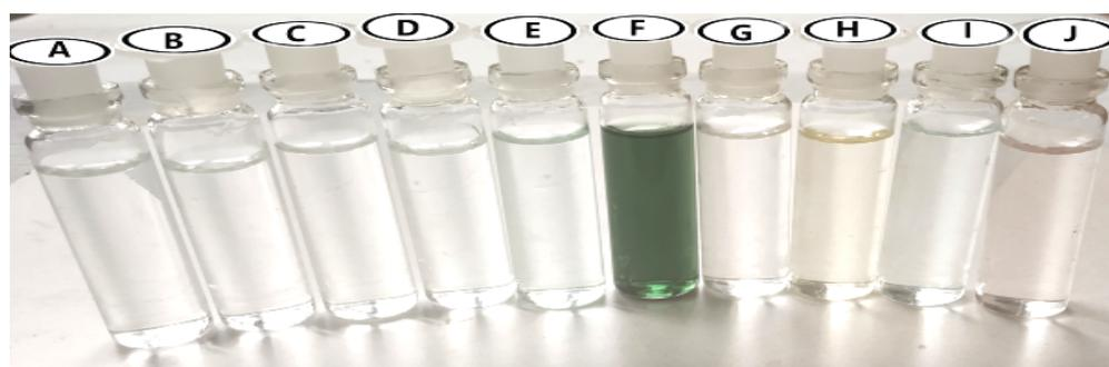
**Figure 2.** Color Response of MAP with different metal ions in alcoholic medium at ambient temperature , A)  $Mn^{+2}$ , B)  $Mo^{+6}$ , C)  $Cd^{+2}$ , D)  $Pb^{+2}$ , E)  $Ni^{+2}$ , F)  $Fe^{+3}$ , G)  $Zn^{+2}$ , H)  $Hg^{+2}$ , I)  $Au^{+3}$ , J)  $Co^{+2}$ .
