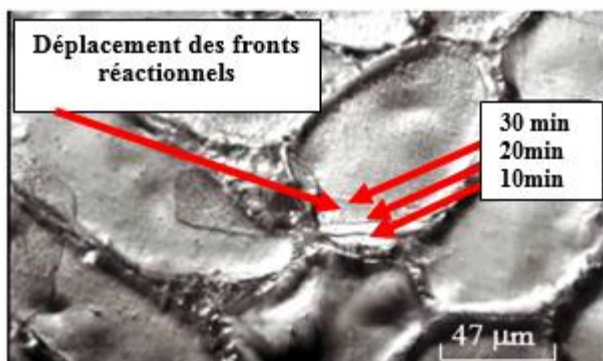
Figure 13 : Visualisation des déplacements des joints de grains dans l'alliage PbCa0,058%Sr0,12%Ag0,3% maintenu à 80°C après 3 attaques chimiques successives après la trempe : \Delta t=10 min.
