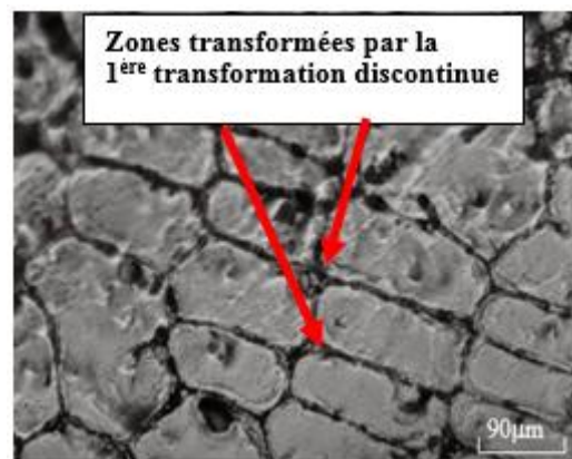
Figure 6 : Structure de la trempe de l'alliage brut de coulée PbCa0,058%Sr0,12%Ag0,07% trempé à l'eau marquée par des zones transformées par la 1ère transformation discontinue.
