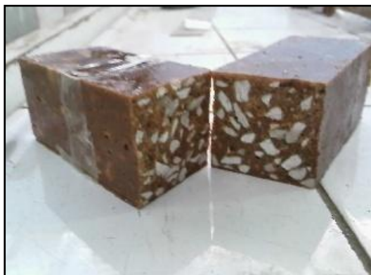
Figure 12 : Exemple du mode de rupture d'un béton de résine sans fibres en flexion 3 points
