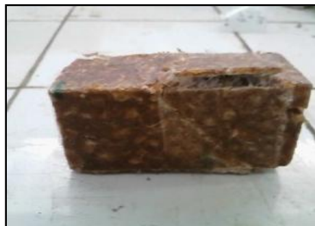
Figure 17 : Exemple de mode de rupture en compression d'un béton de résine renforcé de 3% de fibres de verre injectée de façon aléatoire.
