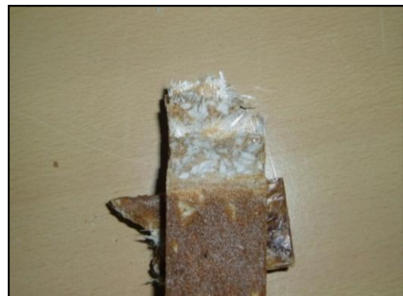
Figure 13 : Mode de rupture en flexion 3 points d'un béton de résine renforcé de 4% de fibres injectée de façon aléatoire
