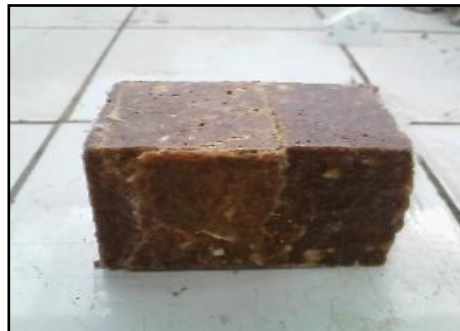
Figure 16 : Exemple de mode de rupture en compression d'un béton de résine sans fibres
