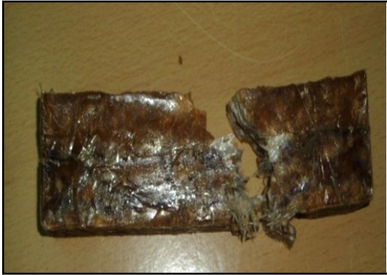
Figure 14 : Mode de rupture en flexion 3 points d'un béton de résine renforcé de deux couches de tissu de verre au milieu
