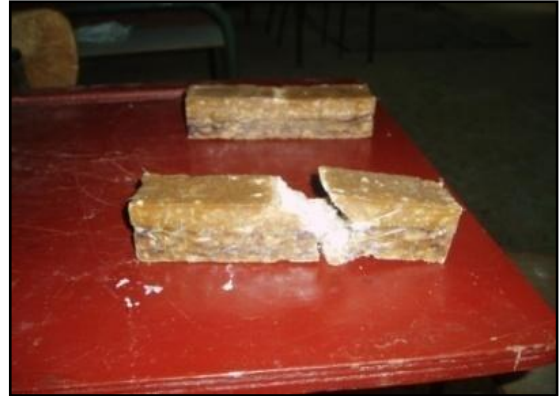
Figure 15 : Mode de rupture en flexion 3 points d'un béton de résine avec trois couches de tissu de verre dans la zone tendue
