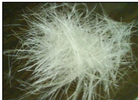
Figure 4 : Fibres de verre E aléatoires
