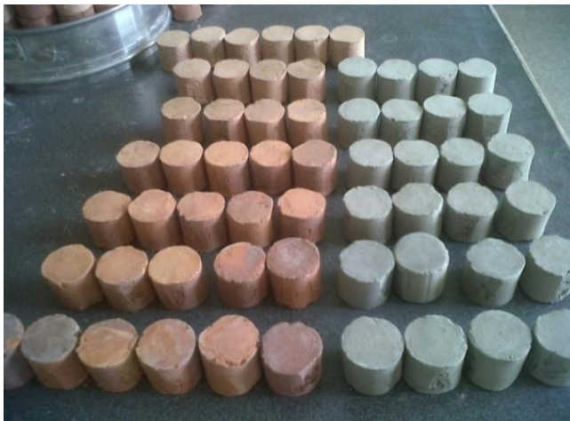
Figure 5 : Echantillons des briques après extrusion
