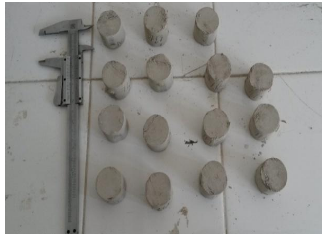
Figure 5 : Echantillons des briques après extrusion
