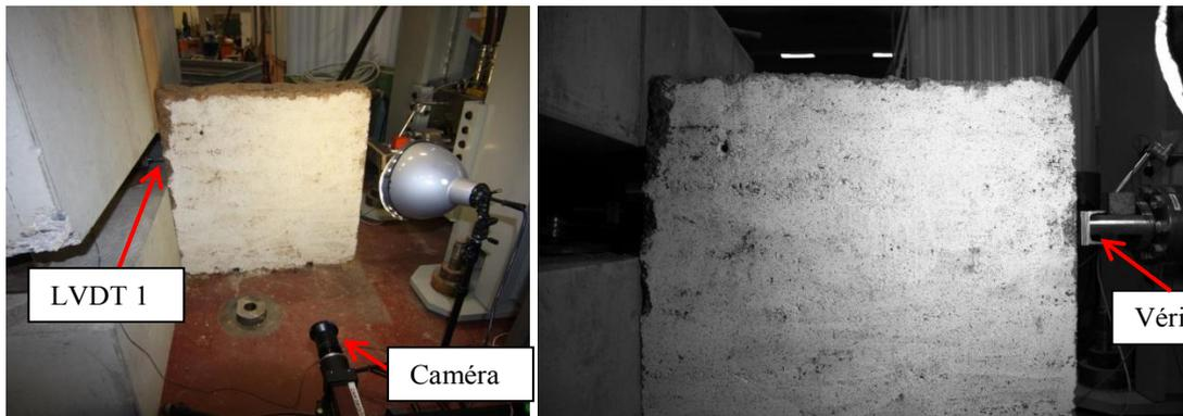
Figure 4: Banc d'essais de cisaillement
