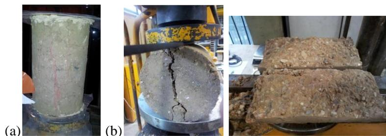
Figure 1: (a) Essai de compression ; (b) Essai de traction par fendage
