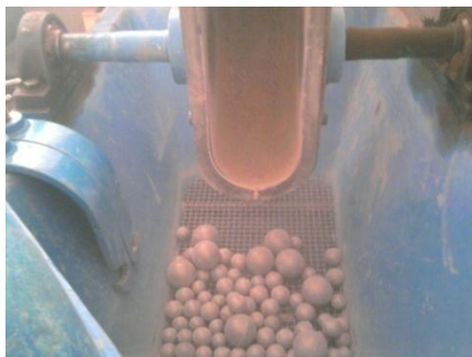
Images 2 et 3 : Broyeur BB10 après broyage d'un kilogramme de ciment avec 20 % de boue lavée
