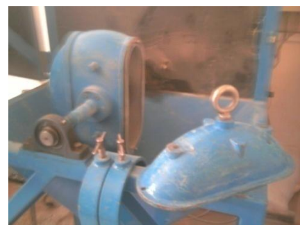
Images 2 et 3 : Broyeur BB10 après broyage d'un kilogramme de ciment avec 20 % de boue lavée
